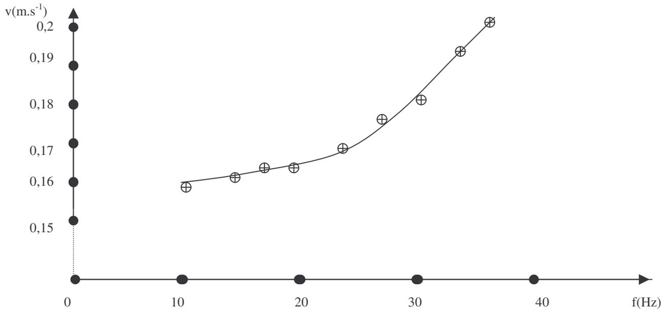
La courbe tracée n'est pas une droite horizontale: la vitesse dépend donc de la fréquence, le milieu est donc dispersif. Les ondes à la surface de l'eau subissent la dispersion.
